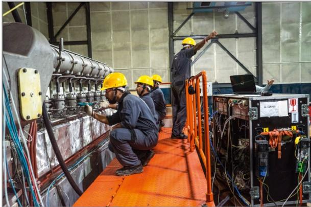
*Motorenprüfstand am Fertigungsstandort von MAN Diesel & Turbo in Aurangabad, Indien*
