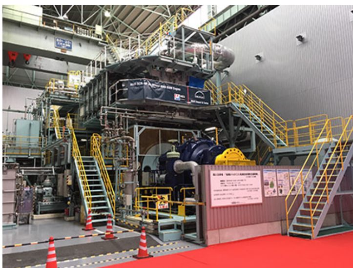
Der Mitsui-MAN B&W 4S50ME-T9 Testmotor, der die neue MAN SCR-HP-Technologie enthält
