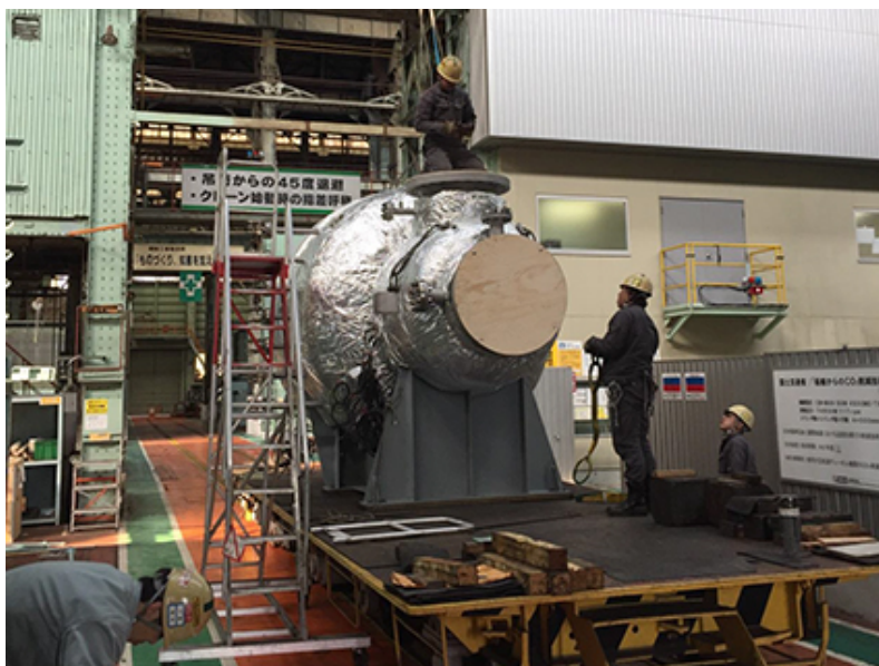
Der SCR-HP-Reaktor in der Fabrik von Mitsui in Tamano
